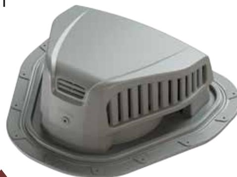
Данная модель точечных аэраторов служит для организации проветривания подкровельного пространства крыш, у которых в качестве кровельного покрытия используется гибкая битумная черепица или фальцевая кровля. Аэратор устанавливается только на смонтированную кровлю.
